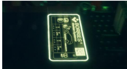
Markier-Beispiel: Laserfolie beschriftet in der Laserkabine
