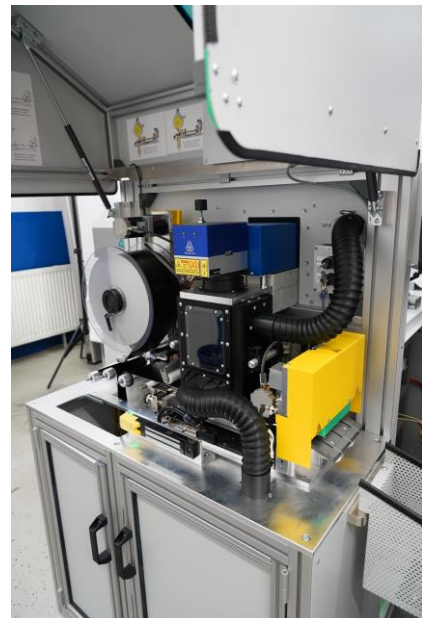
Lösungsbeispiel: Folienvorschubmodul in Laserkabine
