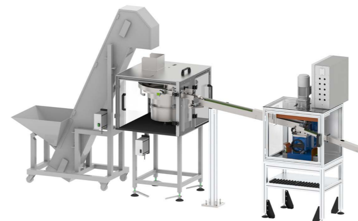
BM 73 EL mit Steilförderer und Vereinzelung mit Teileerkennung
