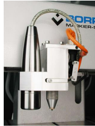
Abb. Prägekopf m. Kamera/Antastung
