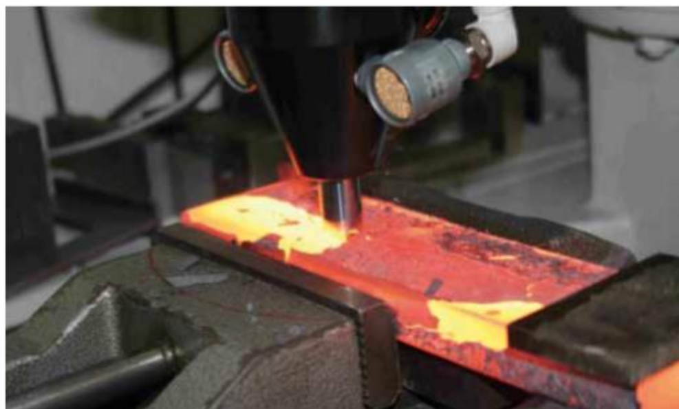
Heißes Eisen: Auch bei Temperaturen von mehr als 1.000 Grad Celsius arbeitet die Prägeanlage laut Hersteller zuverlässig.
